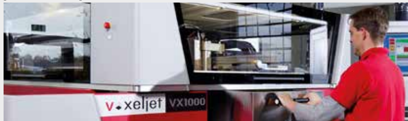
Cette machine industrielle permet de réaliser des moules ou des noyaux en sable utilisés pour réaliser des pièces de fonderie.
