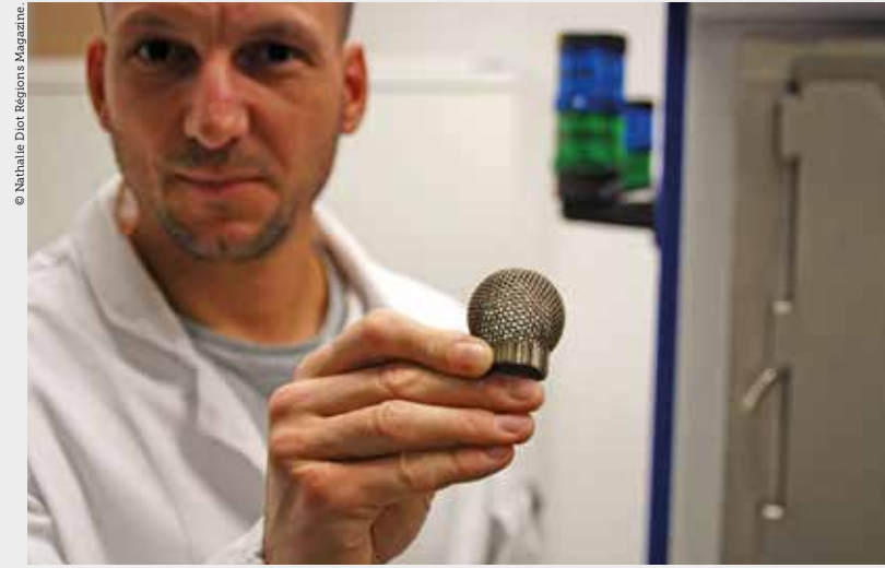
Révolutionnaire, la fabrication se fait de façon additive. Il ne s'agit plus d'enlever de la matière en trop mais d'ajouter juste ce dont on a besoin. Les réalisations peuvent être poussées à leur forme optimum. Nicolas Ponsart montre ici une balle de golf ajourée.
