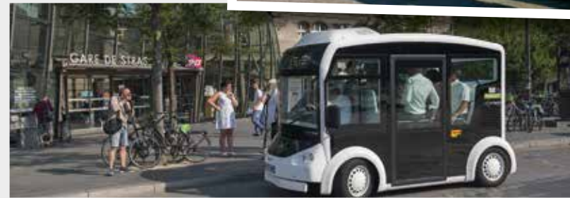
Le véhicule Cristal est 100 % électrique et se conduit en libre-service avec un permis B. Mais il a aussi l'avantage d'être modulable : en y accrochant jusqu'à trois véhicules supplémentaires, le voici transformé en transport en commun pour plus de 70 personnes, avec chauffeur ! Pour les vacances d'été, Cristal a pris le ferry pour se rendre en Corse et rouler aux couleurs de la Communauté d'agglomération Pays Ajaccien.
